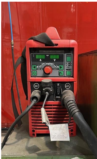
Soldadora TIG AC/DC ideal para soldadura de precisión en materiales aleados.
