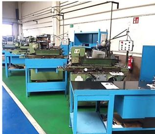
Auxtrol cuenta con varias líneas para la fabricación de **punzones y matrices de corte**: tornos, rectificadoras cilíndricas y tangenciales, electroerosión por hilo y penetración.
