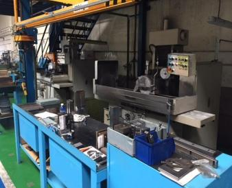
Fabricación de cuñas y portapunzones con cabeza o de cambio rápido. En este tipo de piezas empleamos un centro de mecanizado de 5 ejes, rectificadoras verticales y tangenciales...
